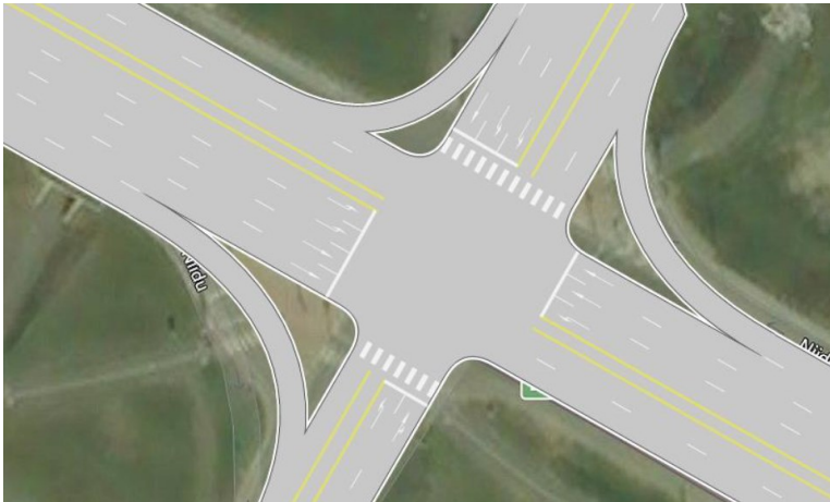
Joonis 1. K-Projekt AS liiklusuuringu väljavõte. Laiendatud foorjuhitav riigitee nr 4 ja Niidu tn ristmik
